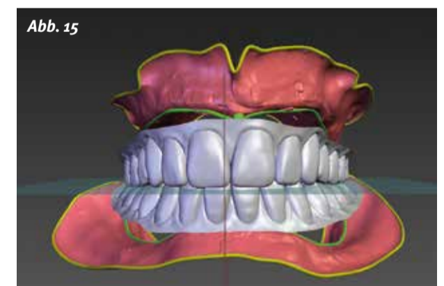
Abb. 15 BD-Creator mit den eingeblendeten Ebenen zur Analyse der richtigen Position. Beispiel: Ein Einser kann nicht auf der Papilla inzisiva sitzen.
