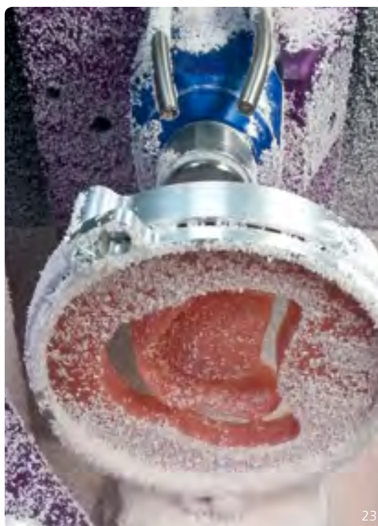
Abb. 21 bis 23 Einspannen des BD Load-Frä- rohrlings in die Haltevorrichtung der Organical Desktop 8 Fräsmaschine (R+K, Berlin) und Fräsprozess im Trockenbetrieb
