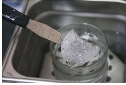
Abb. 6: BD Impress nach dem „Einschmelzen“. Das Material ist im klaren Zustand knetbar.
